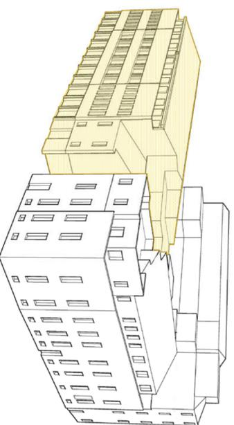
assonometria di progetto-demolizione volumi e nuova costruzione
