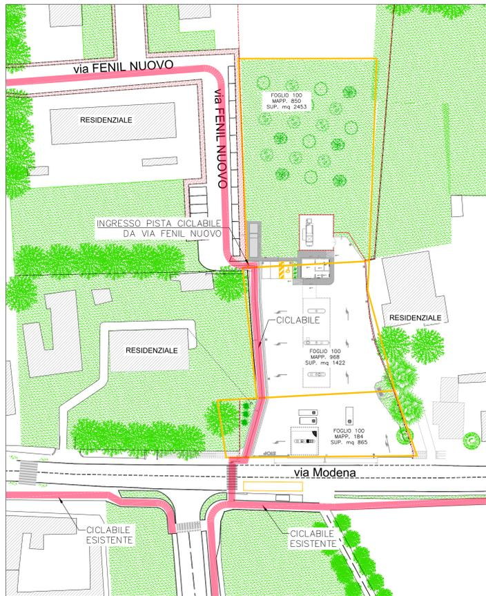
COLLEGAMENTO CICLABILE ESISTENTE/IN PROGETTO PERIMETRO PARTICELLE CATASTALI RICAVATO DA ESTRATTO DI MAPPA CATASTALE IN SCALA 1:2000
