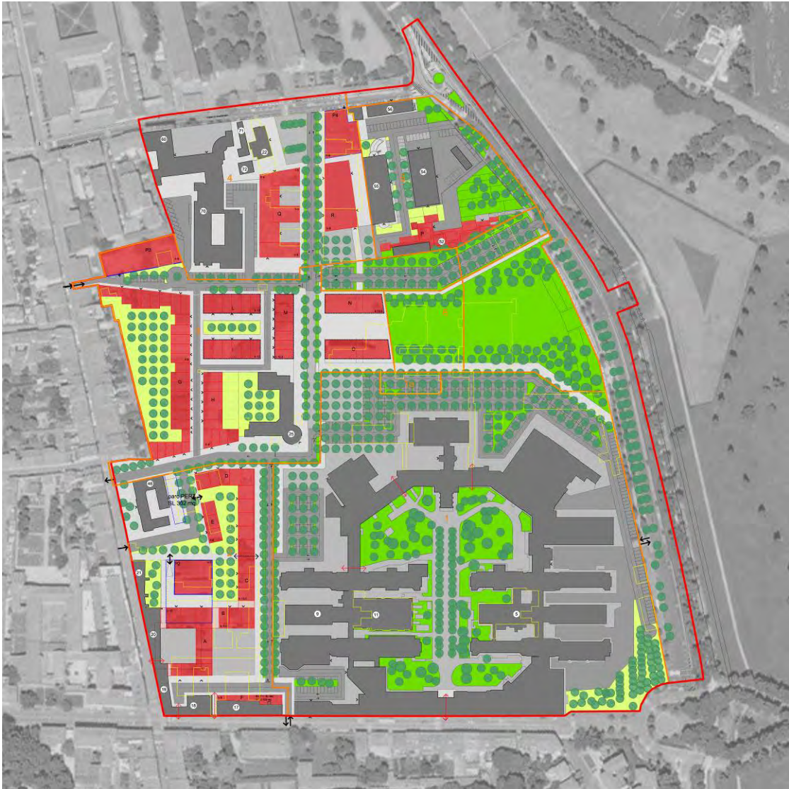
Figura 2. Planimetria del Programma di recupero nell'Area di S. Rocco. Sono evidenziati: in grigio gli edifici esistenti da mantenere, in rosso gli edifici nuovi di progetto, in verde chiaro il verde privato, in verde scuro il verde pubblico
