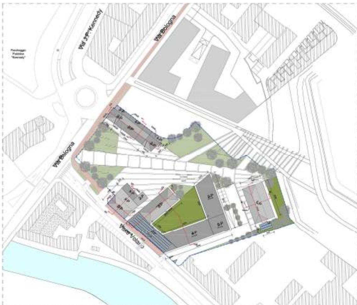
figura 6 – planimetria stato di progetto con indicazione dei numeri di piano degli edifici ed indicazione delle sezioni (estratto tavola U14a)
