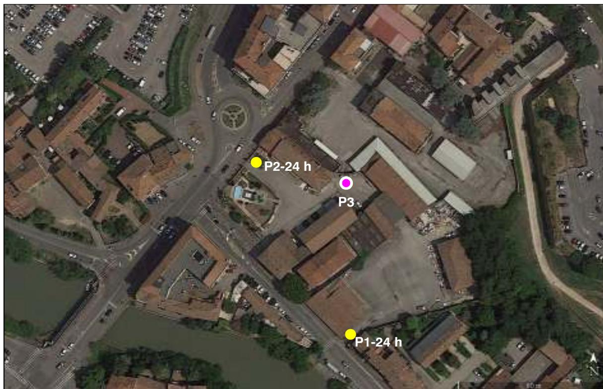
figura 16 – ortofoto (luglio 2017) con indicazione in giallo dei punti di misura da 24 ore ed in magenta del punto di misura “spot”
