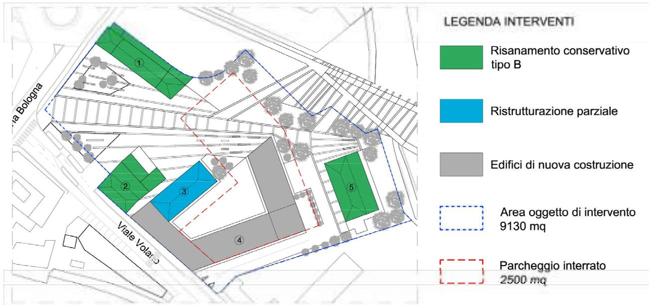
Figura 28: Interventi – Stato di Progetto
