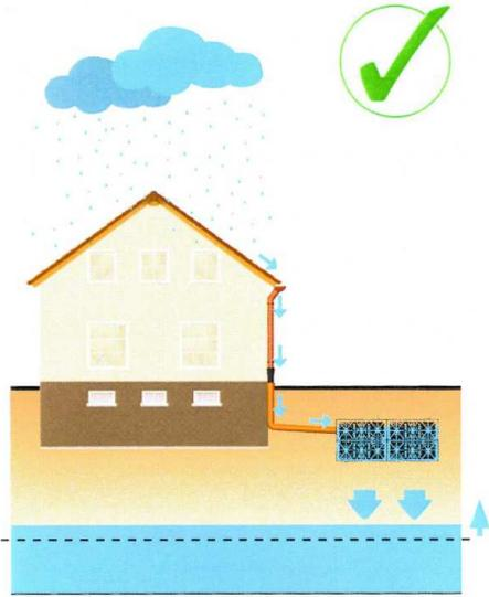
Tra le diverse misure attualmente disponibili per Ottenere l'invarianza idraulica vi sono i bacini di Infiltrazione, sistemi interrati che raccolgono le acque piovane captate dalla rete di drenaggio e ne favoriscono la progressiva infiltrazione nel sottosuolo (qualora le condizioni del sito in esame lo consentano).
