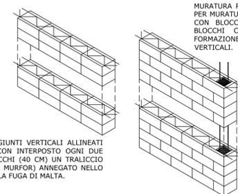
MURATURA A GIUNTI VERTICALI ALLINEATI (A SORELLA) CON INTERPOSTO OGNI DUE CORSI DI BLOCCHI (40 CM) UN TRALICCIO ZINCATO (TIPO MURFOR) ANNEGATO NELLO SPESORE DELLA FUGA DI MALTA.
