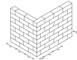
FORMAZIONE ANGOLO SU MURATURA DI SPESORE 20 CM CON BLOCCO SEGATO IN CANTIERE A LUNGHEZZA 45 CM. POSATO ALTERNATO SUI DUE LATI DELLA MURATURA.
