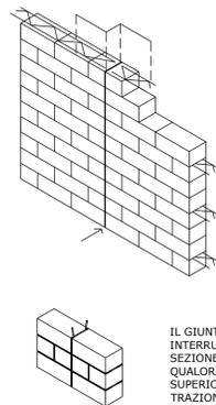
FORMAZIONE DEI GIUNTI DI CONTROLLO DA REALIZZARE SU TUTTE LE MURATURE DI LUNGHEZZA SUPERIORE A 10 ML., CON PASSO VARIABILE DA 5 A 7 ML.
