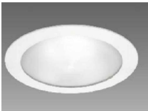
Proiettore da incasso in controsoffitto IP44 con lampada a LED 20W 4000K e vetro stampato anabbagliante con alimentatore elettronico
