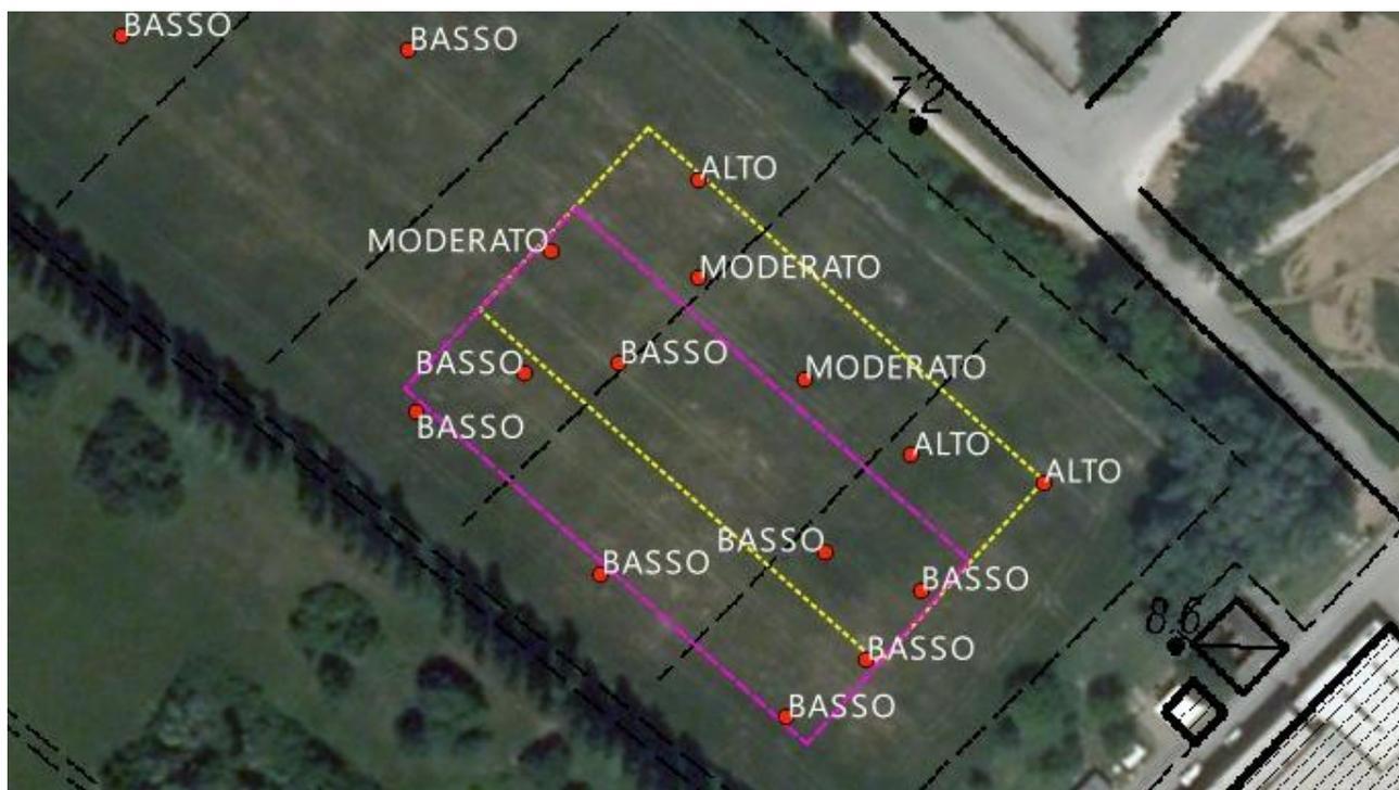
Ubicazione delle CPTU eseguite e relativi rischi di liquefazione calcolati; il rettangolo giallo identifica l'area di sedime iniziale, il rettangolo viola la nuova area di sedime traslata;
