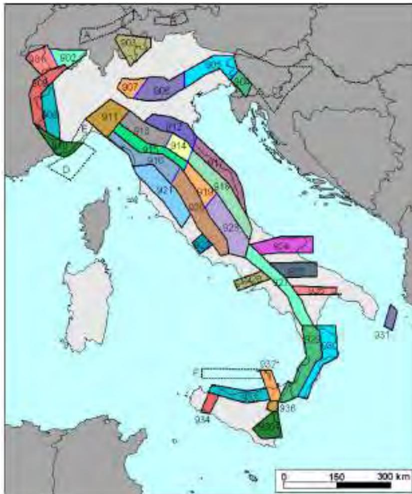
Fig. 7.2 – Zonizzazione sismogenetica ZS9 - Gruppo di lavoro per la redazione di pericolosità sismica (OPCM n. 3274) Istituto Nazionale di Geofisica e Vulcanologia.
