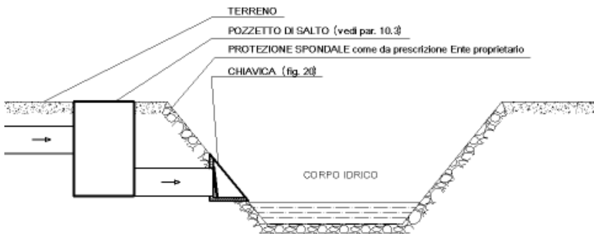
Figura 15: schema indicativo scarico acque bianche in corpo idrico superficiale
