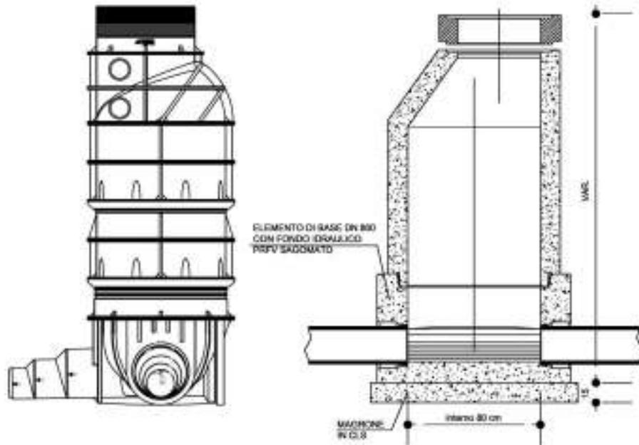
Per fognature di dimensione maggiore del lato del pozzetto di ispezione, questo potrà realizzarsi in posizione disassata rispetto alla condotta (Figura 2).
