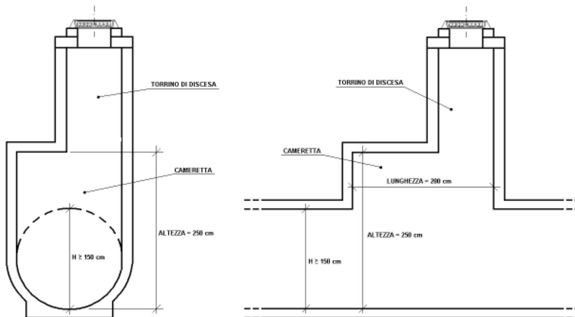
Figura 3: schema per pozzetto d'ispezione su condotte praticabili.
