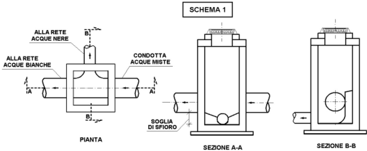
Figura 9: schemi realizzativi per scolmatore di rete mista.
