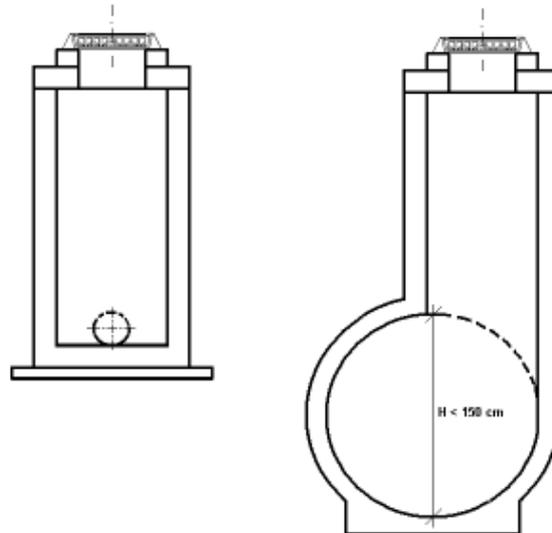
Figura 2: schemi per pozzetto d'ispezione su condotte non praticabili.
