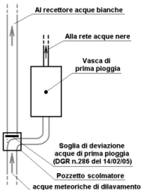
Figura 11: schema realizzativo vasca di prima pioggia.
