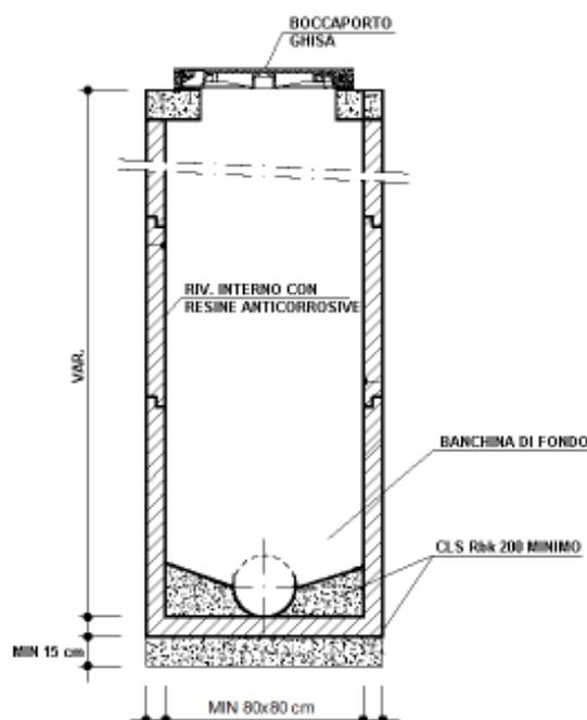
Figura 1: pozzetto d'ispezione.
