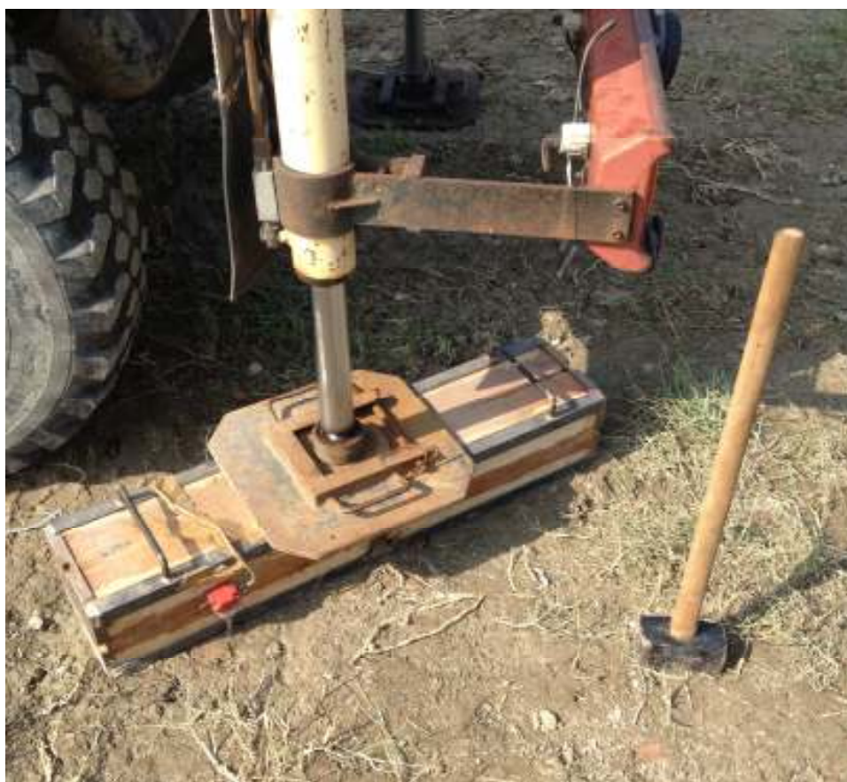
Figura 6 – Particolare sistema di energizzazione
