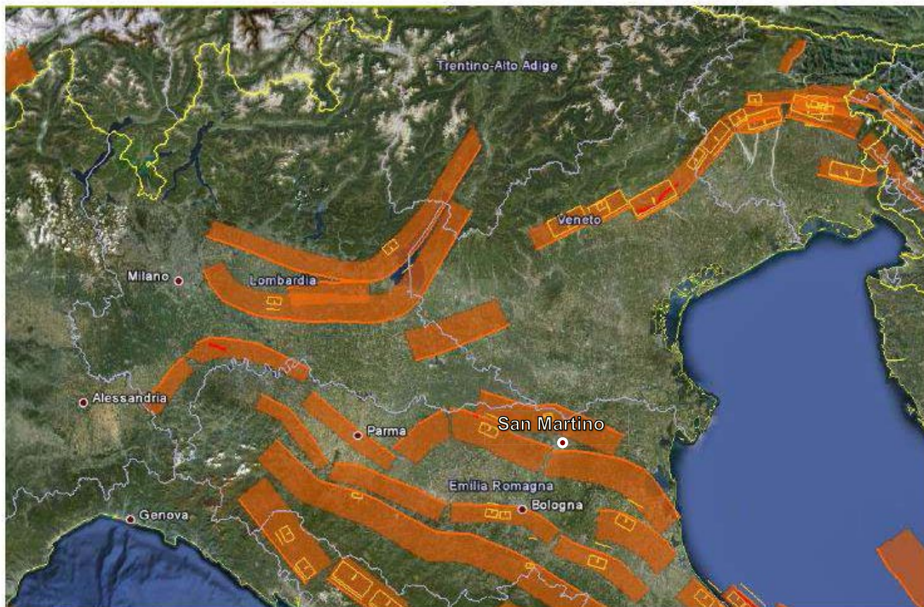
Figura 4 – Scenario sismogenico del nord Italia: le fasce di colore arancio individuano le principali zone per l'insorgenza di possibili manifestazioni sismiche. Fonte: Database of individual Seismogenic Sources (DISS), Version 3.1.1 dell'Istituto Nazionale di Geofisica e Vulcanologia.
