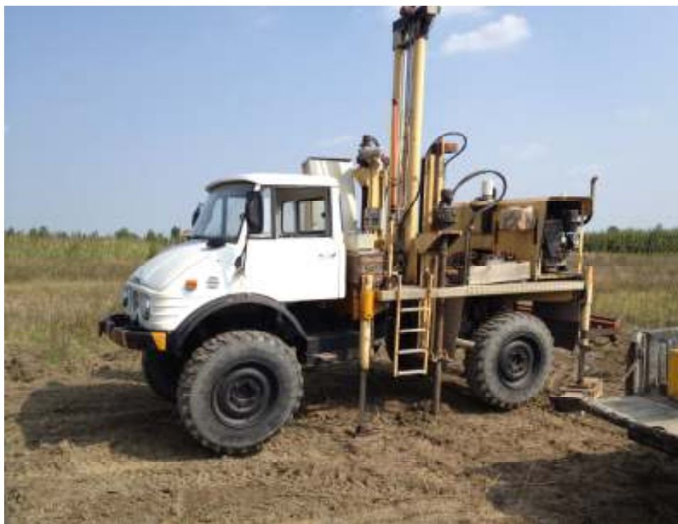
Figura 5 – SCPTU 2 - Penetrometro da 20 ton modello Pagani TG 63/200
