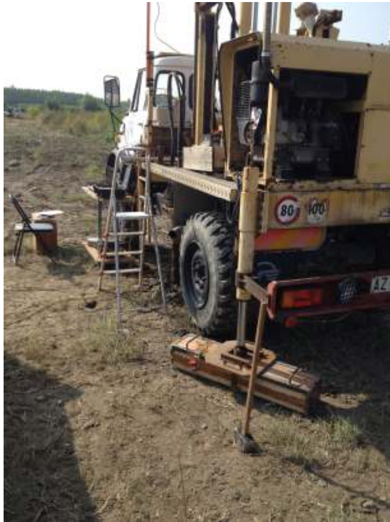
Figura 4 – SCPTU 1 - Penetrometro da 20 ton modello Pagani TG 63/200
