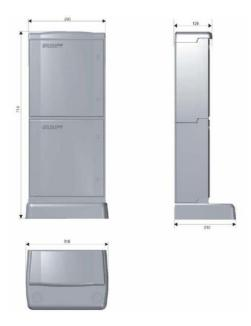
Colonnina modulare in PVC dimensioni 293x714mm profondità 126mm.
