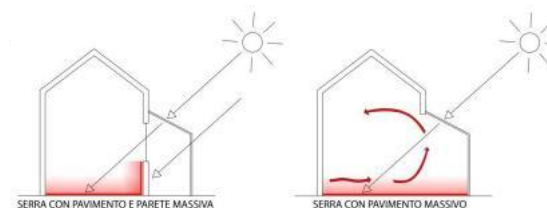
ESEMPI DI SISTEMI DI CAPTAZIONE SOLARE
