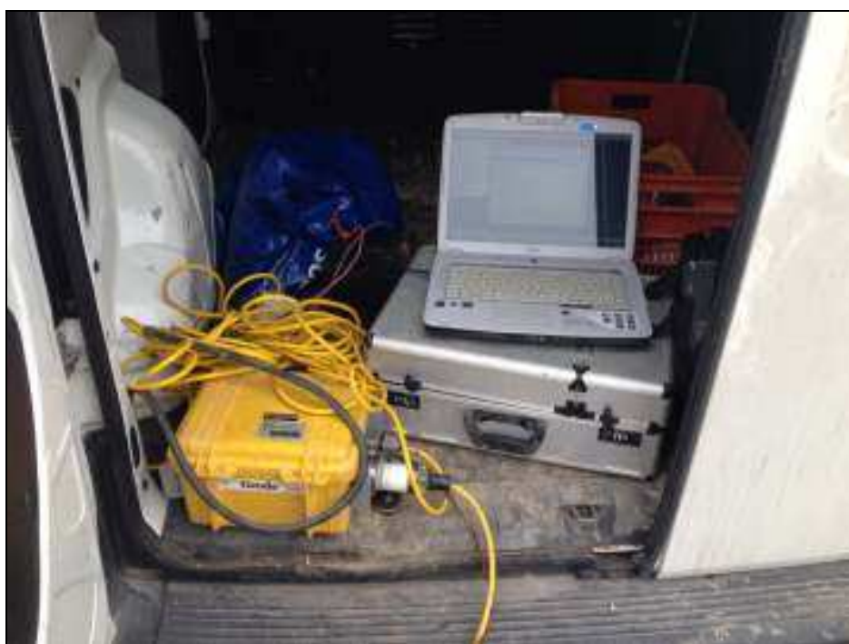
Fig. 3.2: Strumentazione della Geode Geometrics utilizzata per l'esecuzione dell'indagine sismica MASW e Re.Mi.
