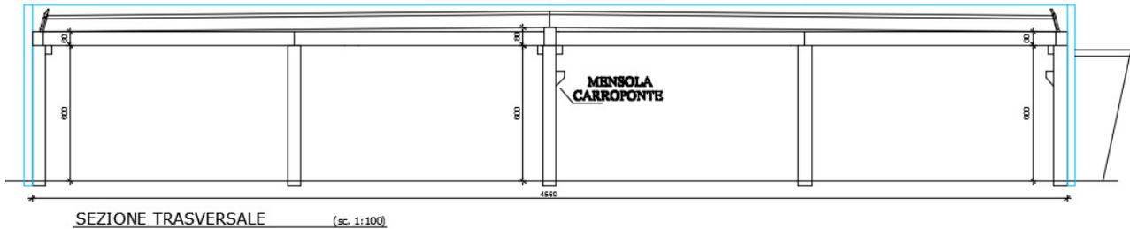
i pilastri sono prefabbricati e di dimensioni 60x60 per la zona monopiano e 80x80 per i quattro pilastri che oltre a sostenere la copertura, hanno la funzione di portare a terra anche i carichi statici e sismici del solaio.
