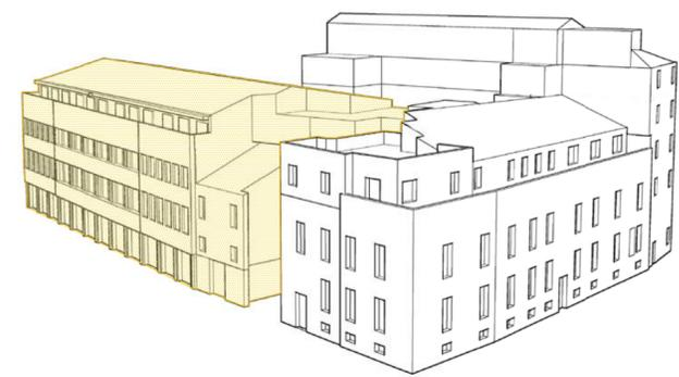
assonometria di progetto-demolizione volumi
