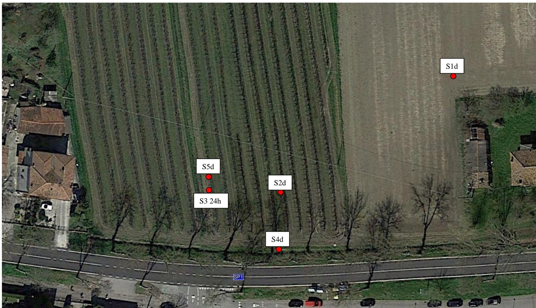
**Fig.2.3:** Vista aerea di dettaglio con ubicazione delle quattro stazioni di misura diurne (S1d, S2d, S4d, S5d) e di quella di lunga durata (S3 24h).
