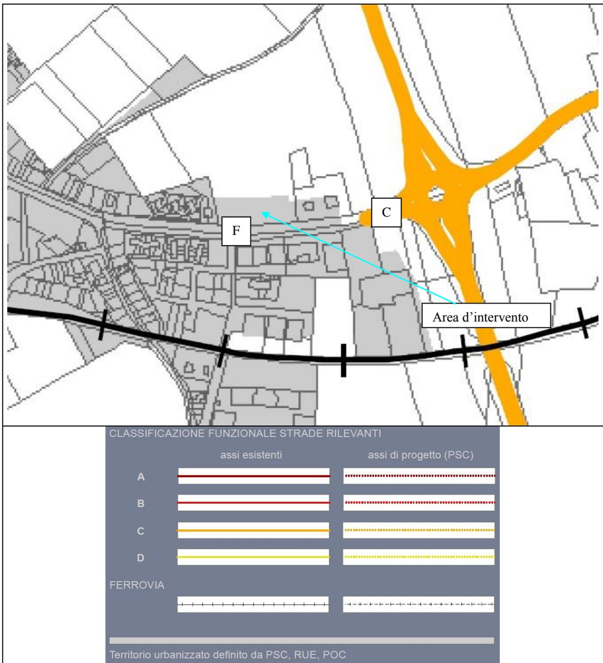
**Fig.3.3:** CLAC di Ferrara, stralcio della tavola 2.2 Quadro conoscitivo infrastrutture di trasporto; nell'area urbanizzata via Comacchio viene classificata come di tipo F, mentre nella porzione extraurbana viene classificata di tipo C.
