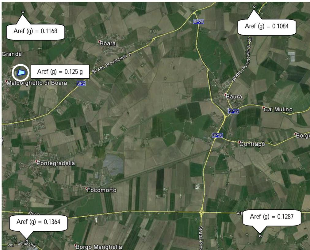
FIGURA 2.1 - Griglia delle accelerazioni al badrock
