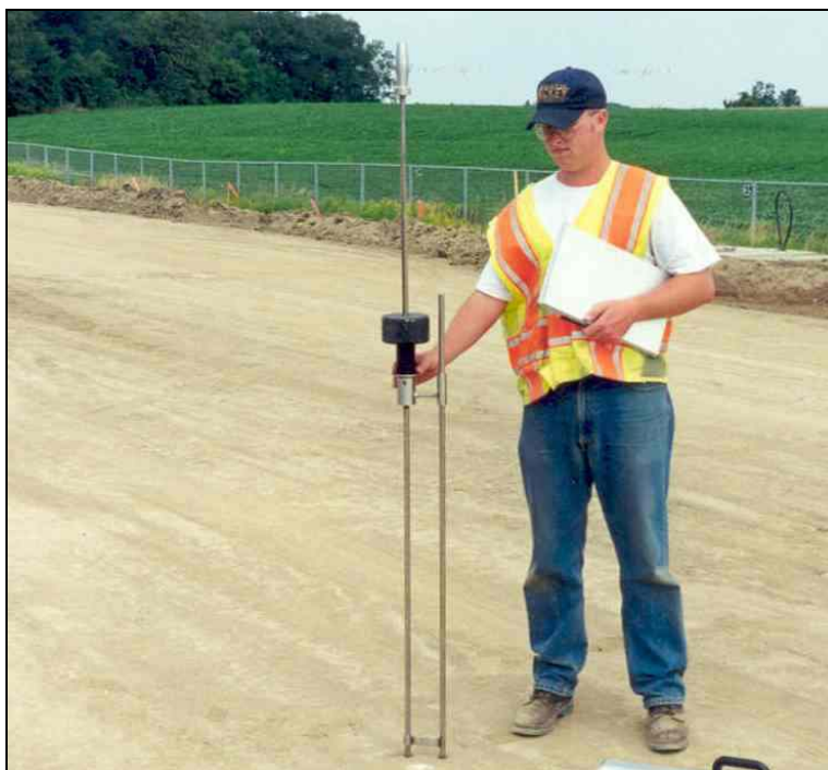
Figura 6: penetrometro dinamico leggero "DCP" standard ASTM D 6951-03
