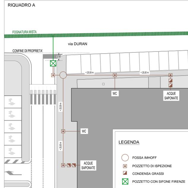
SEZIONE SCHEMA FOGNARIO TIPO - scala 1:50
