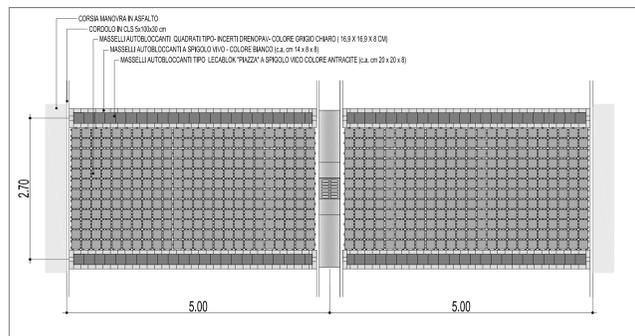
DETTAGLIO PAVIMENTAZIONE MARCIAPIEDE PERIMETRALE EDIFICIO
