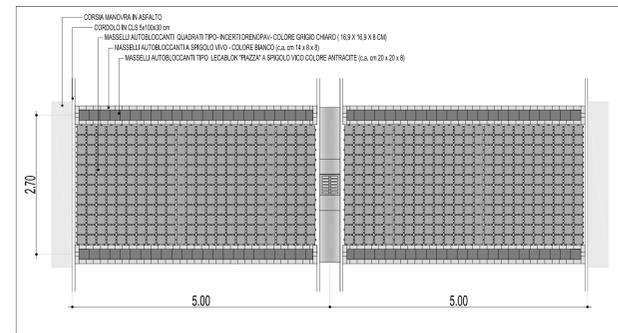
DETTAGLIO PAVIMENTAZIONE MARCIAPIEDE PERIMETRALE EDIFICIO
