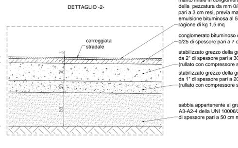
manto finale in conglomerato bituminoso della pezzatura da mm 0/8 di spessore pari a 3 cm resi, previa mano di attacco con emulsione bituminosa al 50% di bitume in ragione di kg 1,5 mq
