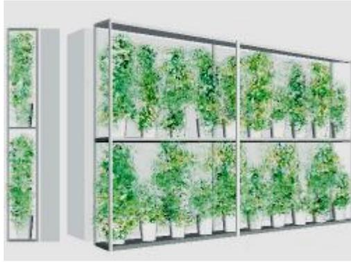
*Fig.4 Schema indicativo di parete verde con messa a dimora delle piante in contenitori: sistema con struttura di sostegno separata dall'involucro.*
