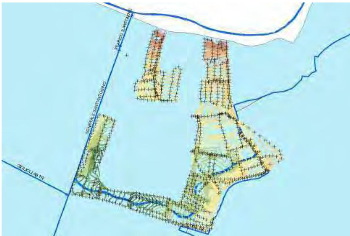
**Figura 41.** Rilievo altimetrico effettuato tramite GPS e curve di livello estrapolate.
