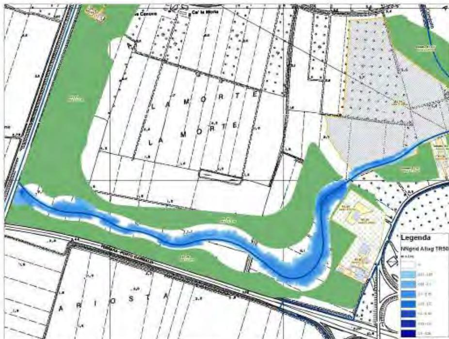
**Figura 97.** Massimi livelli idrici raggiunti nell'area golenale per tempo di ritorno 50 anni - dettaglio sul tratto più critico.
