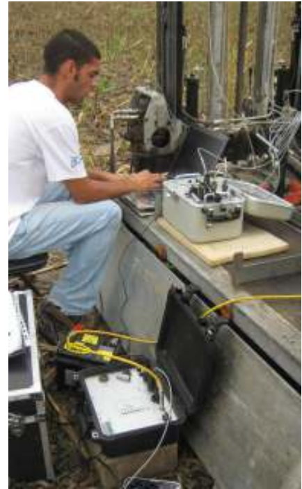
FIGURA 3.5 – Rappresentazione grafica della prova penetrometrica con piezometro sismico
