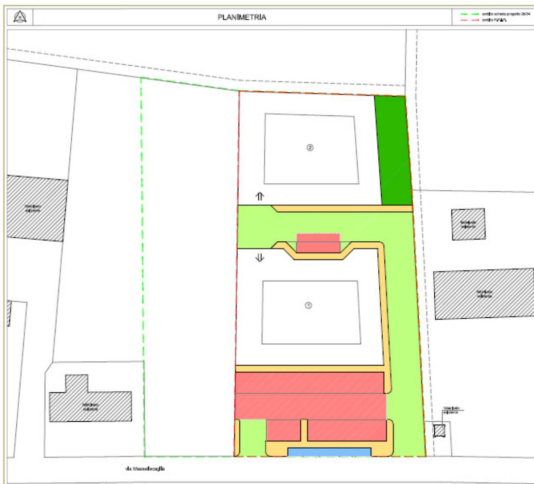
**Fig. 1:** Planimetria generale di progetto, con indicazione dei lotti 1 e 2
