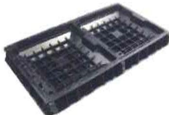
**Chiusino 60x120** a riempimento in ghisa sferoidale classe D 400 (rispondente alla norma EN124). Permette il riempimento con qualsiasi tipo di materiale (porfido, basoli, granito), in modo da mantenere la continuità della pavimentazione.
