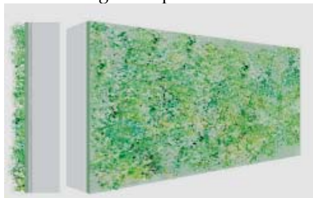
Fig.2 Schema indicativo di parete verde integrata in aderenza all'involucro con struttura di sostegno
