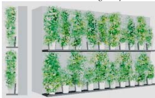
Fig.5 Schema indicativo di parete verde con messa a dimora delle piante in contenitori: sistema integrato nella facciata.
